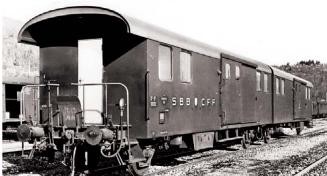
31717 new 05-2009 SBB Sortierwagen D2-D2 50 85 93-33 000-034. Baujahr 1962-1963. Zweiteilige Einheit kurzgekuppelt. Glattes Dach, Fenstergitter. Dach und Stirntüre alu. Epoche III.
