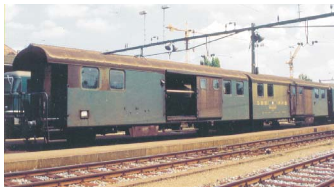
31718 new 05-2009 SBB Sortierwagen D2-D2 50 85 93-33 000-034. Baujahr 1962-1963. Zweiteilige Einheit kurzgekuppelt. Glattes Dach, ohne Fenstergitter. Epoche IV.
